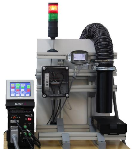
Darüber hinaus verfügt die Steuerbox über eine vorkonfektionierte Leitung für den I/O Eingang des Generators, wodurch dieser bei unterschreiten des Grenzwerts automatisch ausgeschaltet werden kann.
